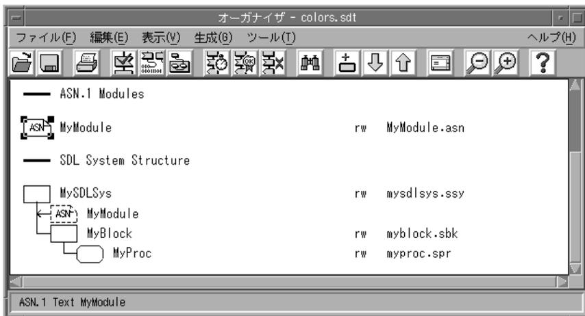
図47: ASN.1モジュールを使用するSDLシステムのオーガナイザ画面
